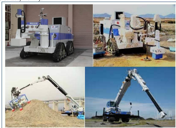
Fig. 8.- Pruebas de evaluación del empleo de GPR sobre vehículo robóticos (Japan Science and Technology Agency, Shibuya-Property-Tokyu Bldg., 10F, 1-32-12 Higashi, Shibuya-ku, Tokyo 150-0011, JAPAN; Tokyo Denki University, Ishizaka, Hatoyama-machi, Hiki-gun, Saitama 350-0394, Japan; University, 1-33 Yayoi-cho, Inage-ku, Chiba 263-8522, Japan; Fuji Heavy Industries Ltd., 1-1-11 Yonan, Utsunomiya, Tochigi, 320-8564, Japan)
